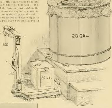
FIG. 2—E. D. TOWNSEND'S ARRANGEMENT OF STRAINER AND SCALES, ILLUS-TRATING THE HUTCHINSON AUTOMATIC ALARM.
