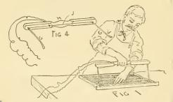
ELECTRIC IMBEDDER IN OPERATION.
